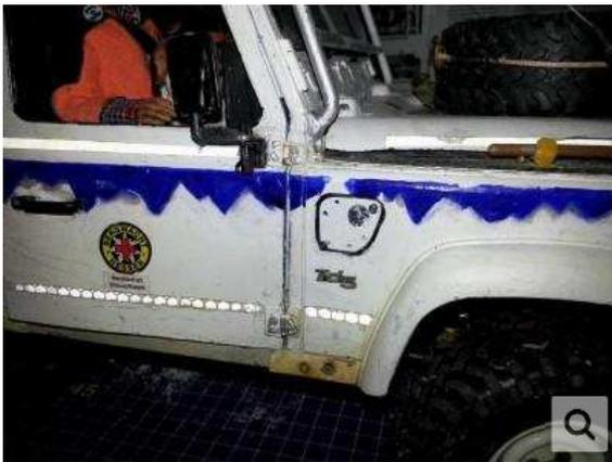
Die neue Platte befestigt (angeklebt und zur Zierde mit kleinen Schrauben aus Knupfers Sortiment).
