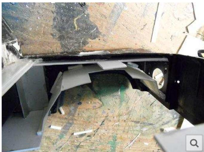
Dann das alles mal auf das Chassis gestülpt, hierbei hilft übrigens, daß die Holme in der Hecktür überstehen, an die Heckstoßstange anstoßen und so die Karosserie von hinten angedockt wird und dann vorne abgesenkt genau über den Motor gleiten kann.
