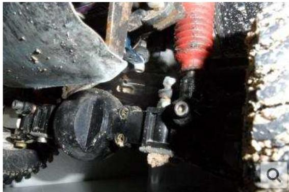
Das Gelenk ist im Übrigen dünnst durchgeschliffen, der Haltestift in der Mitte vielleicht noch 0,1mm dick und unter dem Bruch vom "Öhrchen" ist das Metall auch übelst abgeschabt.
