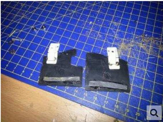
Aus dem Flugmodellssport die Scharniere, von Servos die goldenen Röhrchen aus dem Beipackzeug in die Löcher in der Stoßstange geschoben,
