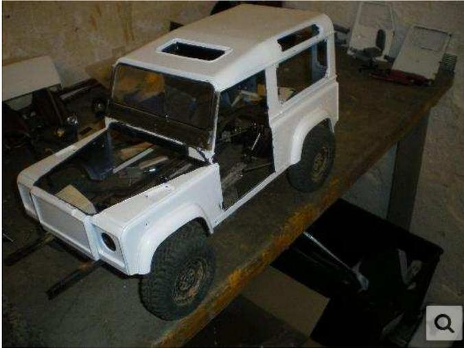
Dann kamen die Achsen. Leicht modifiziert, aber auch noch nicht komplett fertig bearbeitet. Die Aufhängungsadapter an der Achse werden noch abgeschliffen usw.
