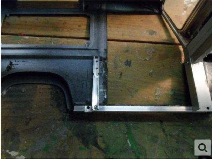
Der Innenraum wird in zwei Schlitzen durch die Mittelholme getragen. Genial, das er genau dort gekappt worden ist.
