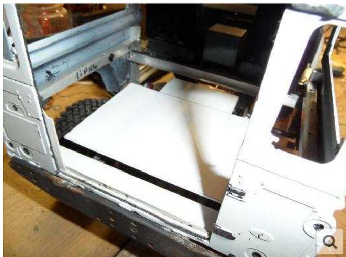
Der Innenausbau wird einfach an den Alurahmen geschraubt. Immer von unten, um ihn zur Not abnehmen zu können. Einzig an der Mittelstrebe liegt er später von oben auf, aber durch kippen von hinten kann er eingesetzt werden.
