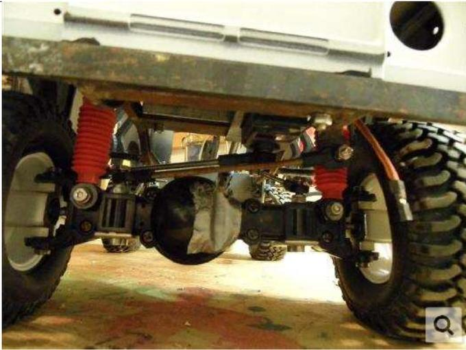
Von vorne nach hinten geblickt einmal ein Bild der Aufhängung. Die Federaufnahmen sind von Hugo und Goose an der Drehbank gefertigt, auch die Federn sind noch testweise drin, steht ja das Gesamtgewicht noch nicht fest. Die massive Brücke ist nicht unbedingt schön, schreit aber irgendwie nach einem Belastungstest - sprich, wenn die Achse bricht, könnte sie das Teil noch zusammenhalten 🙄
